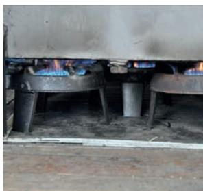
Fig. 22.27. Chauffage, trois brûleurs alimentés par trois bonbonnes de gaz
