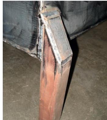
Fig. 22.11. Réalisation des 2 pieds et assemblage sur la cuve
