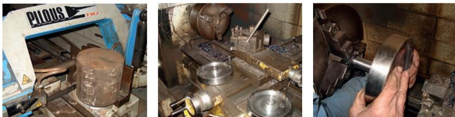
Fig. 22.8. Étapes de fabrication des 2 roues métalliques
