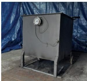
Fig. 22.24. Cuve principale, thermomètre et sonde de température
