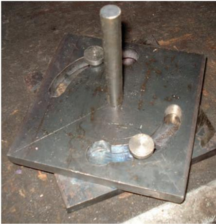
Fig. 22.5. Plaques d'assemblage pour solidariser ou désolidariser les 2 cuves
