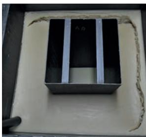
Fig. 22.26. Cuve d'encirage complète avec son bac central
