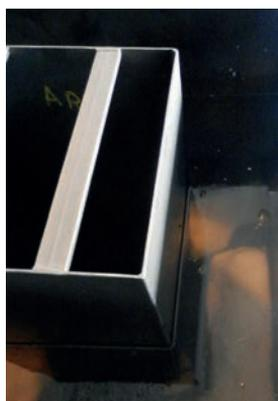
Fig. 22.21. Fonte partielle de la cire microcristalline
