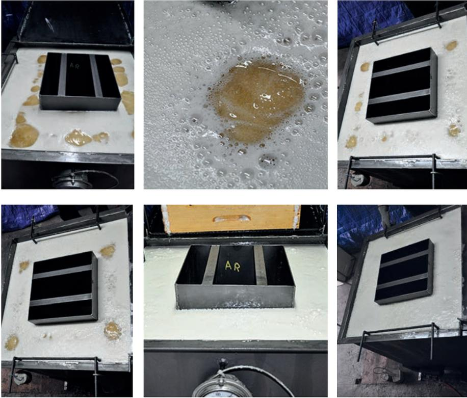
Fig. 22.34. Ruche immergée, l'humidité sort du bois et provoque le bouillonnement de la cire
