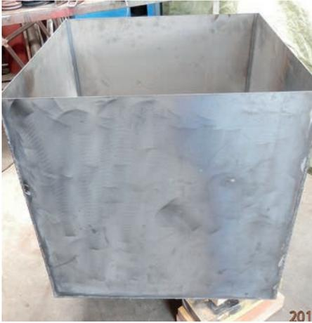
Fig. 22.3. Cuve principale soudée
