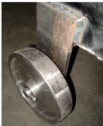
Fig. 22.9. Fixation de la roue arrière sur la cuve
